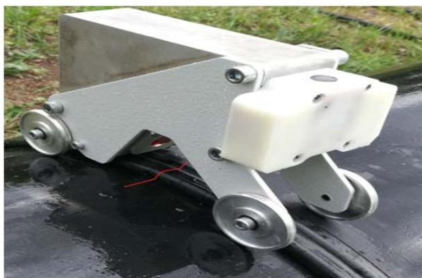
Рис. 5. Мобильный сканер для измерения формы сваренного в полевых условиях грата реальных трубопроводов
