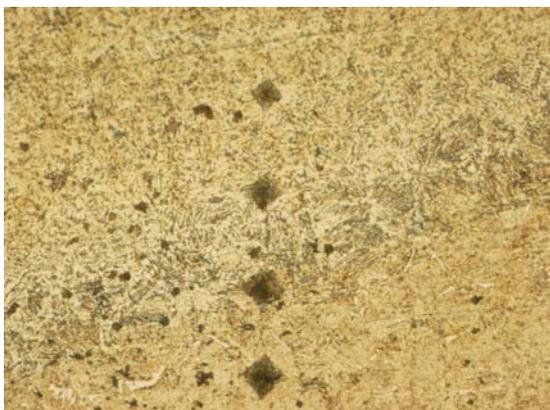
Рис. 4. Переход закаленной зоны в последнем треке в ЗТВ под треком (×500)
