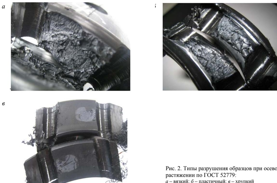
Рис. 2. Типы разрушения образцов при осевом растяжении по ГОСТ 52779:
