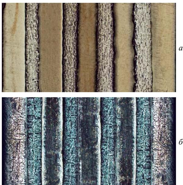
Рис. 2. Микроструктуры титано-стальных композитов системы ВТ1-0+ сталь 08кп+ВТ1 – после СВ+ГП (а) и последующей ТО 1000 °С (б), 10 ч ×50
