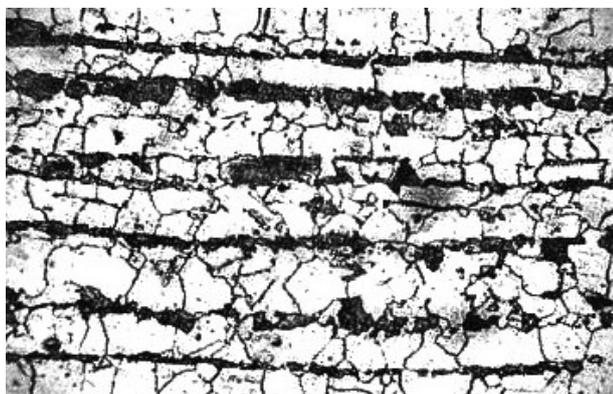
Рис. 1. Строчечная ферритно-перлитная структура стали 14Г2,  $\times 200$
